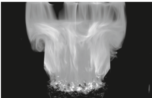
Rysunek 13. Prawidłowy obraz ognia w palenisku.
